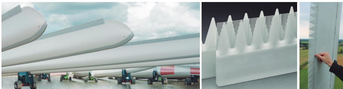
Photographies de pales dotées de Dinotails (peigne / dentelure)
